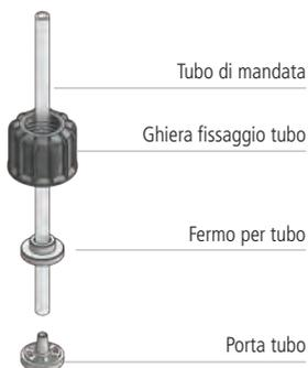
Serrare il tubo sul corpo pompa avvitando la ghiera **con la sola forza delle mani**.
